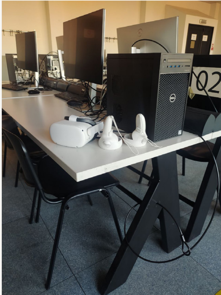
▲ Rys. 3.1.2: Stanowisko robocze, składające się z komputera stacjonarnego, zestawu słuchawkowego i kontroleró
